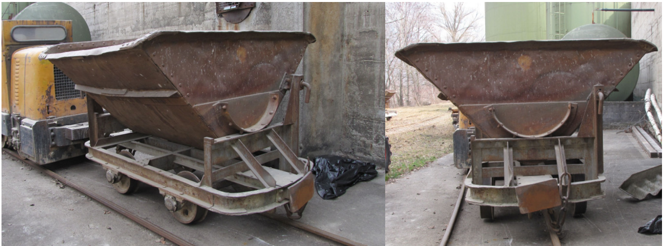
Die entgleiste Lore. Auf dem rechten Bild wird der markante Seitenversatz deutlich.
