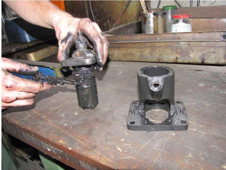
Die Einspritzpumpe nach dem Ausbauen Bild: Remo Hartmann
